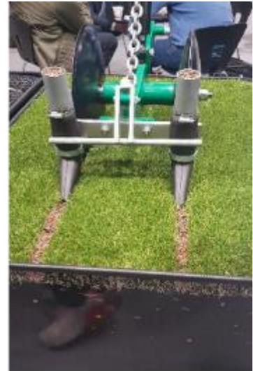
Diversi elementi di distribuzione dell'effluente/digestato con relativo effetto di distribuzione rispetto all'apparato radicale della coltura.
